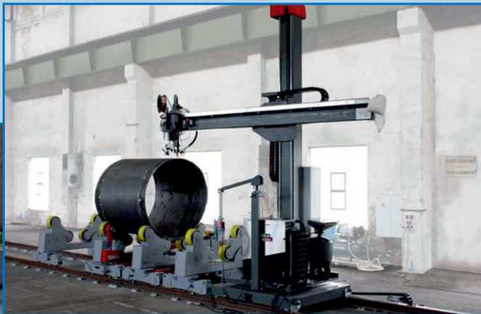
Okretaljke za konzolne aparate za zavarivanje od 5 do 150 tona
