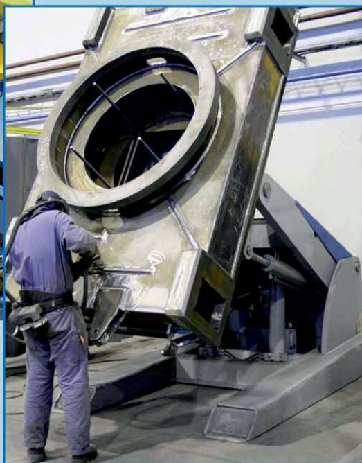
Rotacione stege - pozicioneri sa paralelnim podizanjem, iskošenjem i funkcijom rotiranja do 250t
